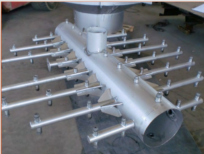
Tubazione distribuzione H2O
