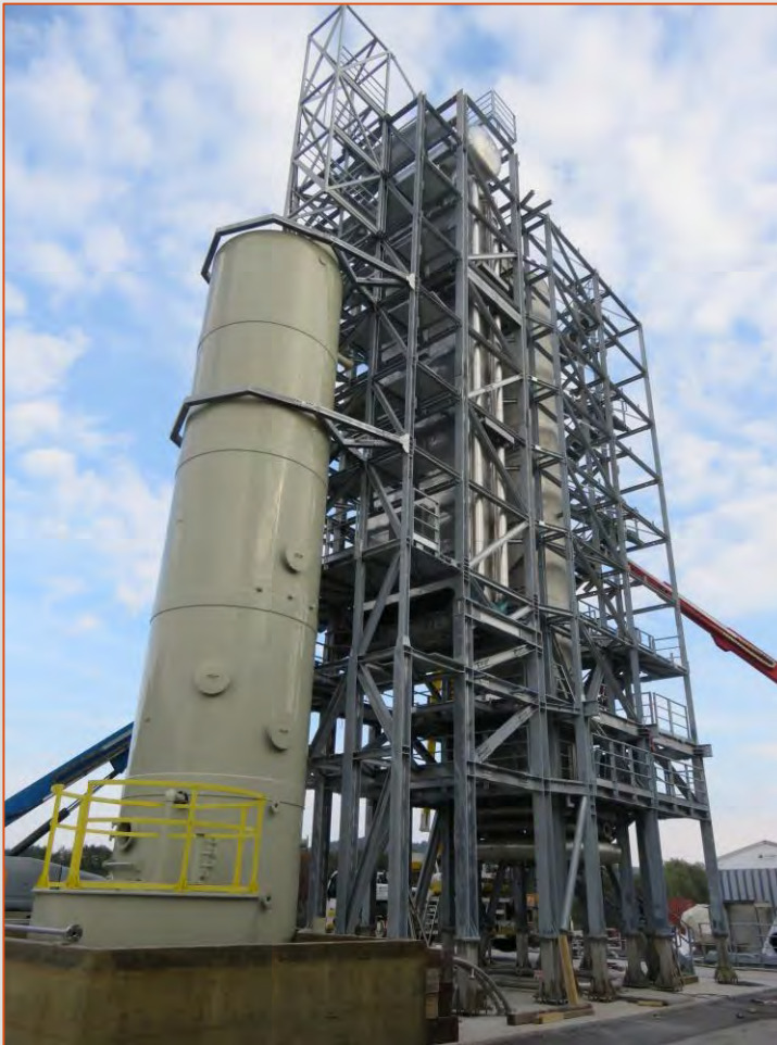
Impianto per produzione pigmenti industria chimica (Augusta – Georgia USA). Reattori di Processo, Draft-Tube (acciaio speciale AVESTA 2205), Piping, Serbatoi di stoccaggio, Strutture - Costruzione, spedizione e installazione on site
