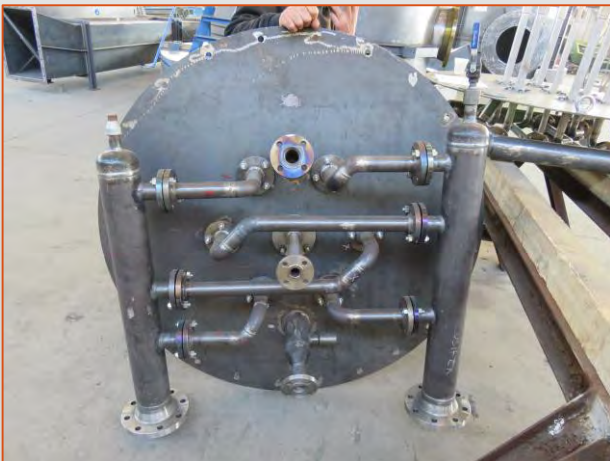
Bruciatore completo di lance, ugelli gas e pilota in AISI310 - Star Aegean Refinery Aliaga (TR)
