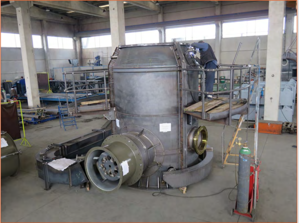
Torcia di terra per raffineria completa di bruciatore e condotti fumi e gas - Stanlow Refinery - Ellesmere Port (UK)
