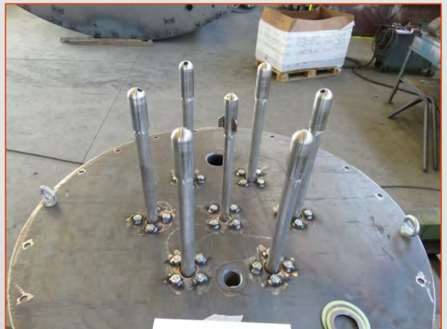
Bruciatore completo di lance, ugelli gas e pilota in AISI310 - Star Aegean Refinery Aliaga (TR)
