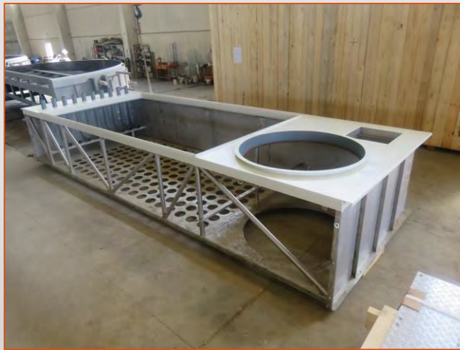
Sistema di depolverazione per cementificio con filtro a maniche, impianto di produzione cemento – Schelklingen, Germania
