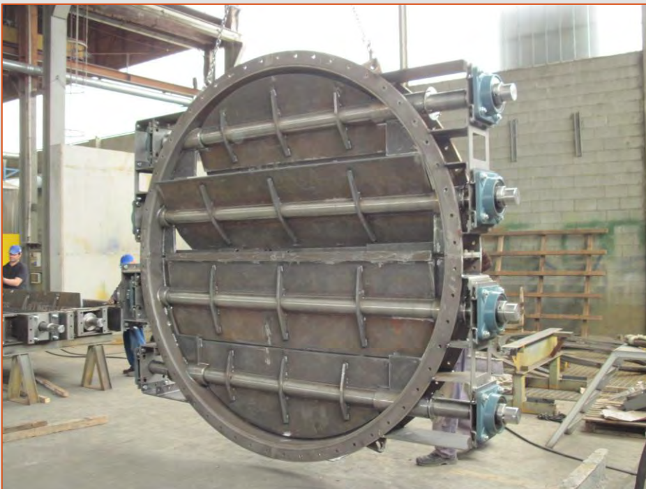
Valvola a farfalla per bypass fumi impianto di produzione Coatzacoalcos, Messico
