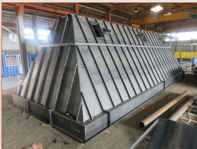
Sistema di depolverazione per cementificio con filtro a maniche, impianto di produzione cemento – Schelklingen, Germania
