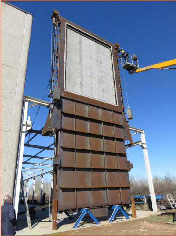
Serranda a ghigliottina in corten, sezione di passaggio fumi 6 x 6 m, alta 15 metri – Raffineria di Anversa (Belgio)
