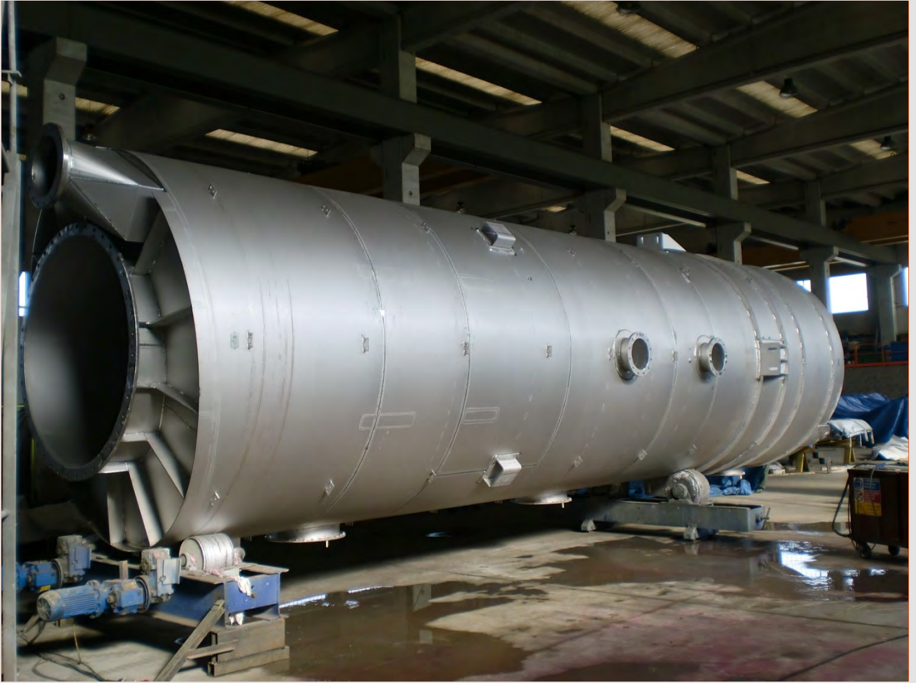
Scrubber trattamento emissioni gassose in acciaio inox 254SMO
